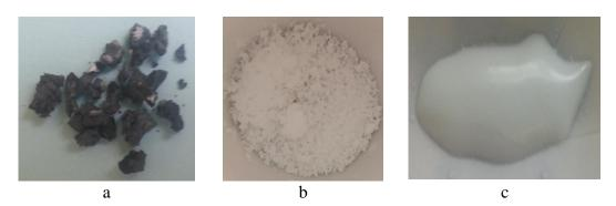
**Fig. 10** Samples of ceramics:  $a - 800 \,^{\circ}\text{C}$ ;  $b - 1300 \,^{\circ}\text{C}$ ;  $c - 1500 \,^{\circ}\text{C}$
