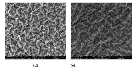
**Figure 6.** SEM micrographs for: (a) CA substrate; (b) 40-ly rGO FM; (c) 60-ly rGO FM; (d) 80-ly rGO FM; (e) 100-ly rGO FM.
