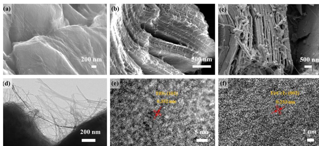
**Figure 1.**  $\text{Ti}_3\text{C}_2\text{T}_x$ ,  $\text{Ti}_3\text{C}_2\text{T}_x$  treated at 6 M KOH for (a) 10 h, (b) 20 h, (c) 30 h; 20h- $\text{Ti}_3\text{C}_2\text{T}_x/\text{TiO}_2$  NWs (d) TEM images, (e-f) HR-TEM images.
