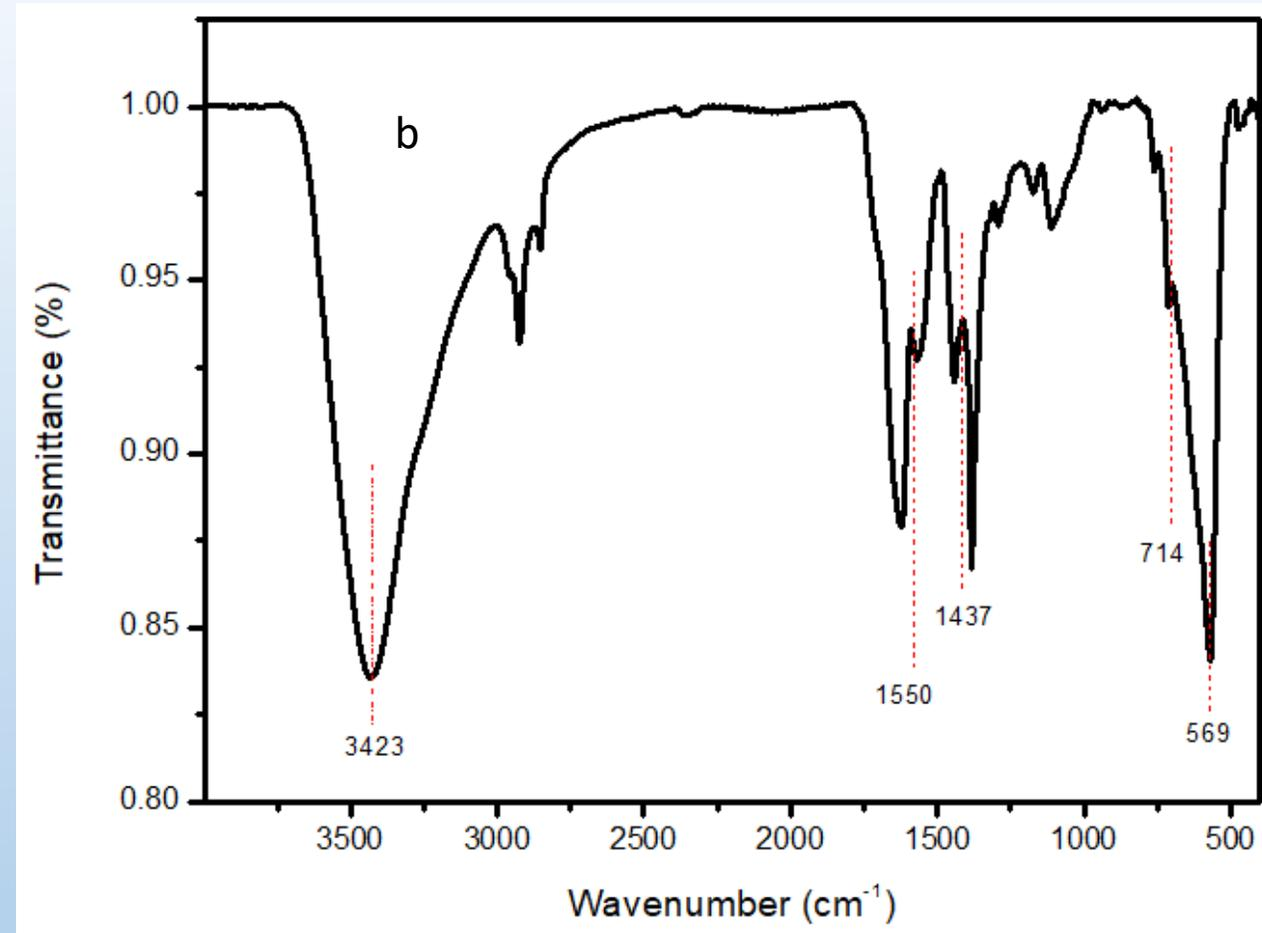
a) XRD for  $\text{Fe}_3\text{O}_4@MIL-100(\text{Fe})-\text{Au}$ ; b) FTIR of  $\text{Fe}_3\text{O}_4@MIL-100(\text{Fe})-\text{Au}$
